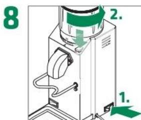
8 グラインダーの刃が触れた場合は、すぐに電源を切り、ホッパーを反時計回りに2～3目盛回してください。
