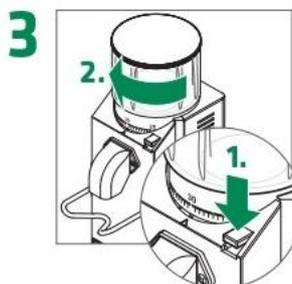
3 ロックボタンを押しながら、ホッパーを時計回りに目一杯回転させます。
